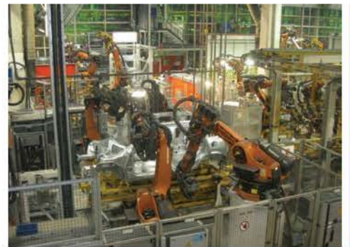
这条车身壳体生产线上共使用了大约 180 个机器人。
