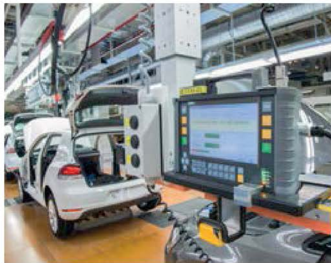
SIDIS Pro “综合检测和加注区”使用了配备 MPS 7 的新的检测台设计方案
