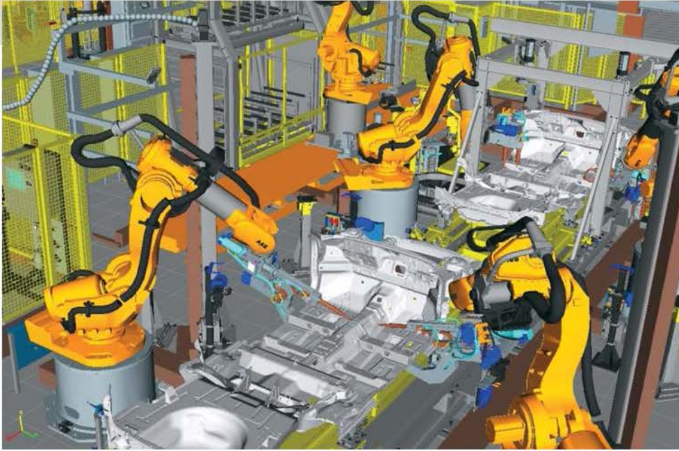
沃尔沃汽车特斯兰大 (Torslanda) 工厂轿厢底板分装线(前面是 V70 轿厢底板, 其后是 V60 轿厢底板) 虚拟仿真
