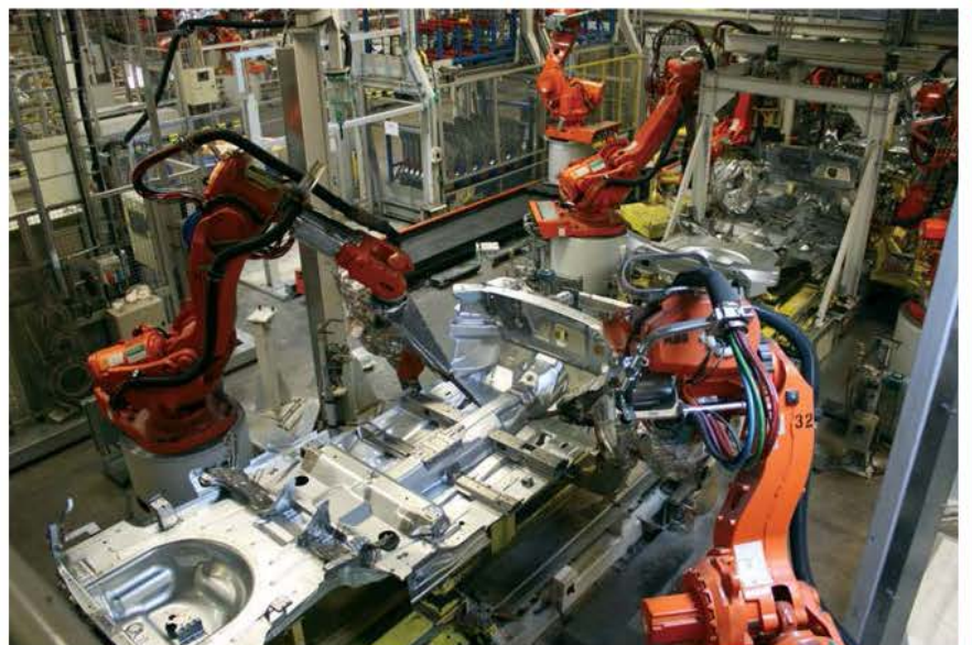
沃尔沃汽车特斯兰大工厂轿厢底板分装线(前面是 V70 轿厢底板, 其后是 V60 轿厢底板) 实际生产线
